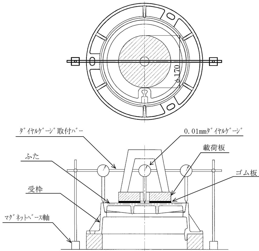
注) 本要領図は試験治具の取付け方法及び位置関係を示すもので製品の形状とは一部異なる部分がある
