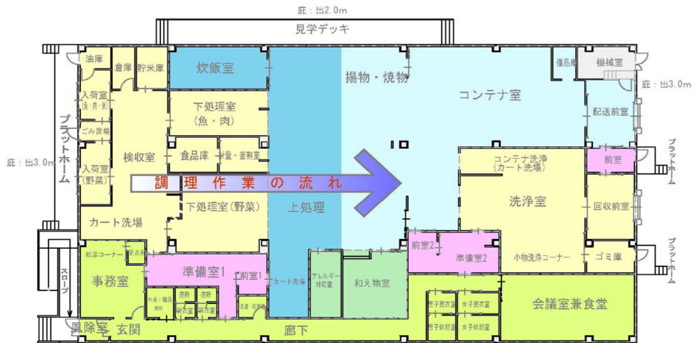
区域の凡例 外来・一般エリア 前室・準備室 非汚染作業区域（加熱後） 非汚染作業区域（加熱前） 高度清潔作業区域 汚染作業区域
