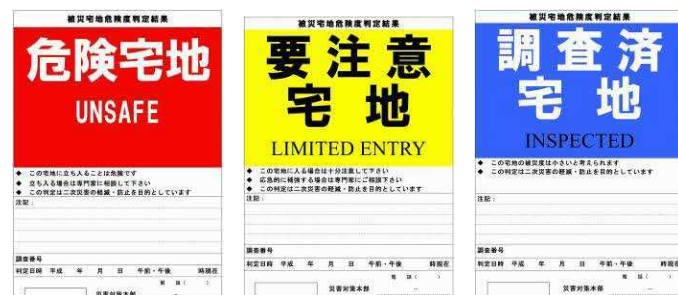
宅地の危険度判定のステッカー
