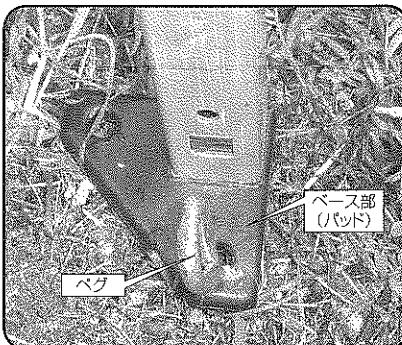
ロープを張れるだけのスペースがない場合は、ベース部(パッド)の穴に、直接ベグをしっかりと打ち込みます。
