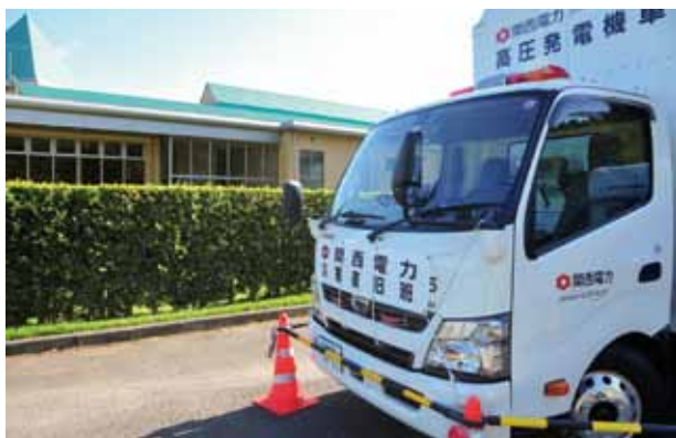
停電時、福祉センターに配備された高圧発電機車
