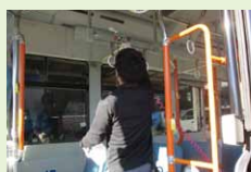
◀光触媒コーティング作業を実施する様子
